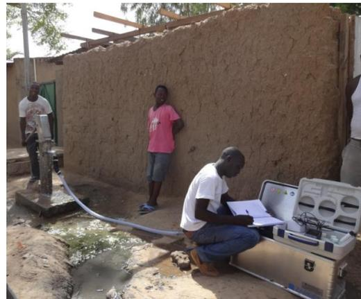
Figure 11 Installation de la cellule d'écoulement à un puits tubulaire à N'Djamena et mesure des paramètres in-situ avec le multi-détecteur WTW-Multi 3430 (Photo: Seeber, 2013).
