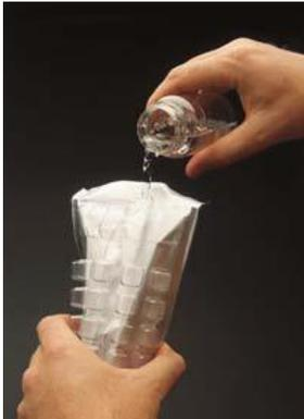
Figure 16 Remplissage du mélange d'échantillon et substrat dans sacs en plastique Quanti-Tray.
