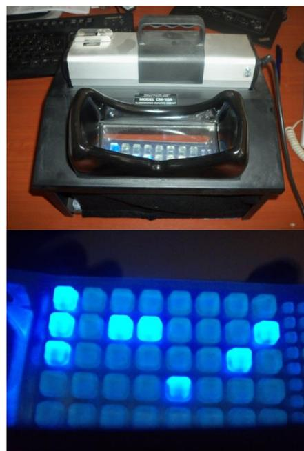
Figure 19 Comptage de puits fluorescent pour E. coli and entérocoques sous lumière UV 365nm et se référer à la table MPN.
