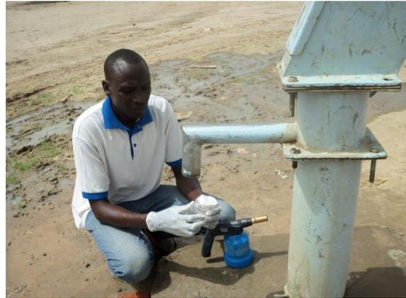
Figure 13 Échantillonnage pour analyse microbienne dans des bouteilles stériles de 100 ml (Photo: Seeber, 2013).
