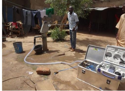
Figure 44 Forage (NDJ 19) dans une cour privée à Chagua avec détection positive d'entérocoques.
