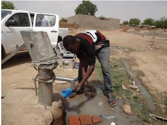
Figure 12 Stérilisation de l'embouchure d'un forage par une flamme avant l'échantillonnage pour analyse microbienne (Photo: Seeber, 2013).
