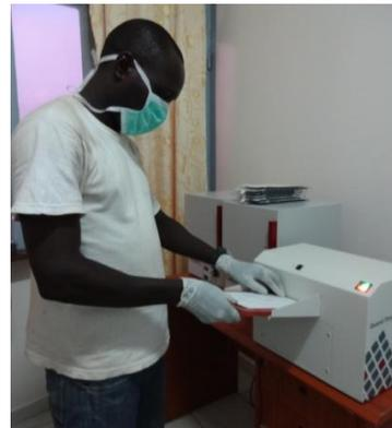
Figure 17 Sceller le Quanti-Tray dans le Quanti-Tray Sealer avant incubation de l'échantillon.
