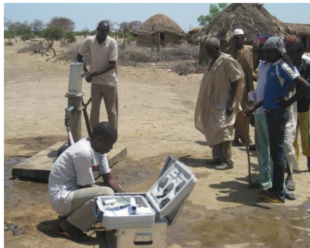
Figure 26. Pompage à travers une cellule de flux et application de la WTW-Multi 3430 (Photo: Djoret Daïra, Mai 2013)
