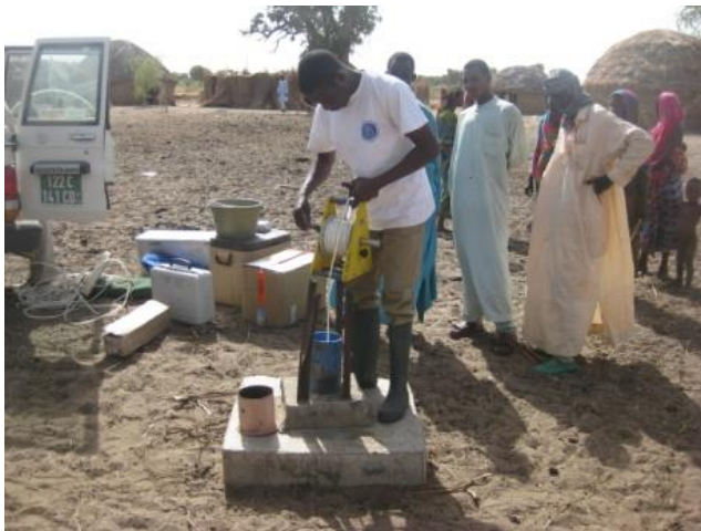
Figure 24. Enregistrement du niveau d'eau dans un piézomètre (Photo: Djoret Daïra, Avril 2013)
