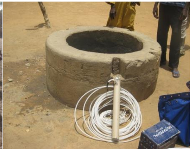
Figure 25. Utilisation de la pompe COMET pour l'échantillonnage à partir d'un puits (Photo: Djoret Daïra, Avril 2013)
