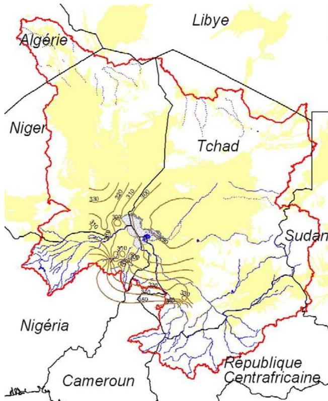
Figure 4.2 Lignes piézométriques pour le Pliocène Inférieur. L'écoulement général des eaux souterraines est indiqué par des flèches en bleu foncé.
