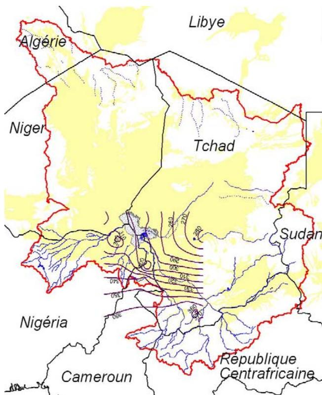
Figure 4.3 Lignes piézométriques pour le Continental Terminal. L'écoulement général des eaux souterraines est indiqué par des flèches en bleu foncé.
