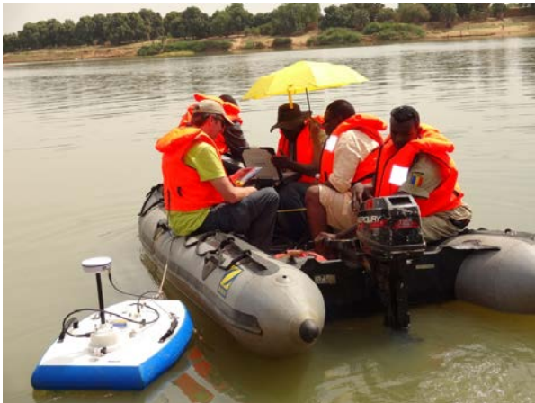
Figure 4 ADCP de la BGR à la station N'Djamena TP
