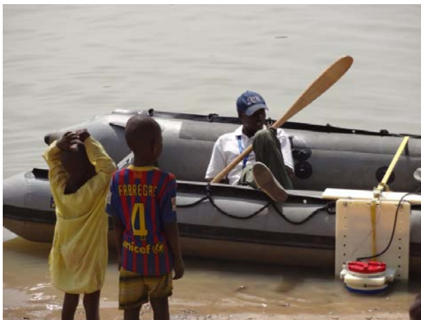
Figure 6 ADCP de la DREM fixé sur un bateau Zodiac +
