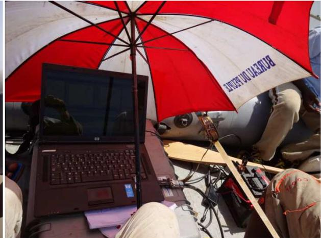
Figure 6 ADCP connecté et fonctionne par un câble de série RS-232 avec un ordinateur et une batterie (Photo Seeber, BGR-CBLT)
