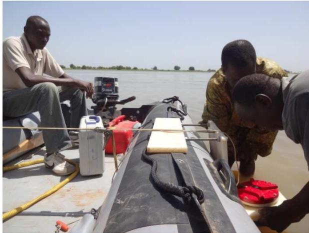
Figure 5 Rio Grande ADCP installée sur un bateau équipé d'un moteur (Photo Seeber, BGR-CBLT)
