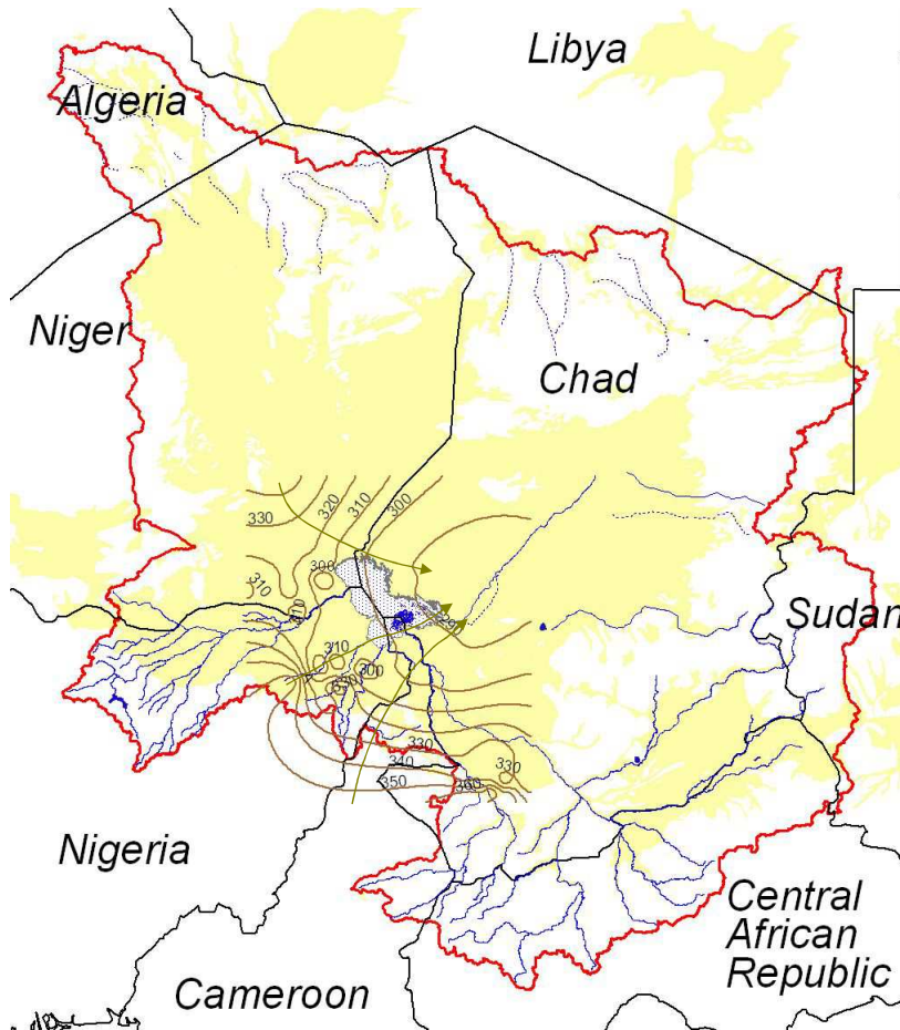
Figure 2.6. Isolignes pour le Pliocène. Les flèches indiquent que l'écoulement régional des eaux souterraines est vers l'est du bassin. Toutefois, les données sont très rares et les résultats doivent être confirmés.
