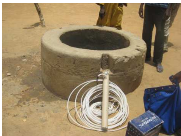
Figure 20 Utilisation du pompe COMET pour l'échantillonnage à partir d'un puits ouvert Biliam Oursi, Tchad (10,55°N 15,23°E) (Photo: Djoret Daïra, CBLT avril 2013)
