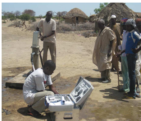
Figure 19 Pompage par une cellule et l'application de la WTW-Multi 3430 à Woulki, Cameroun (12,48°N 14,62°E) (Photo: Djoret Daïra, CBLT mai 2013)
